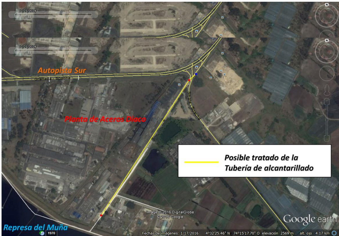
Figura 1. Corredor de estudio para la ubicación de la tubería de alcantarillado en la zona industrial del Muña.
